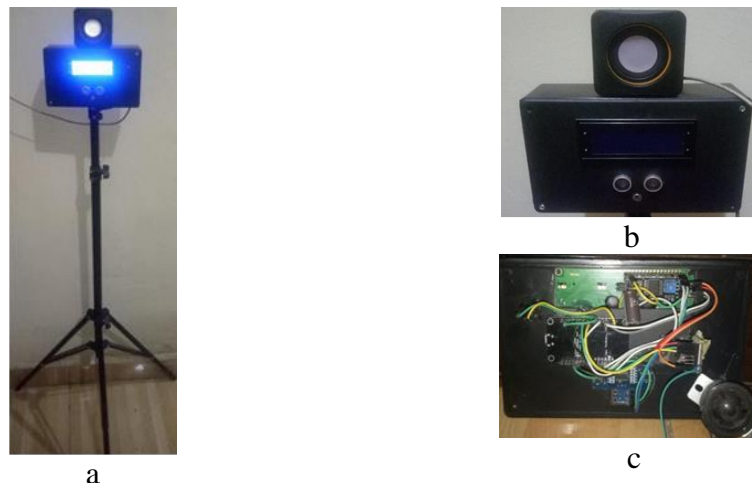
Gambar 4. Implementasi alat deteksi suhu badan bagi penyandang tunanetra; (a) Pemasangan alat menggunakan trimpot, Alat tampak depan (b), Alat tampak dalam (c)
